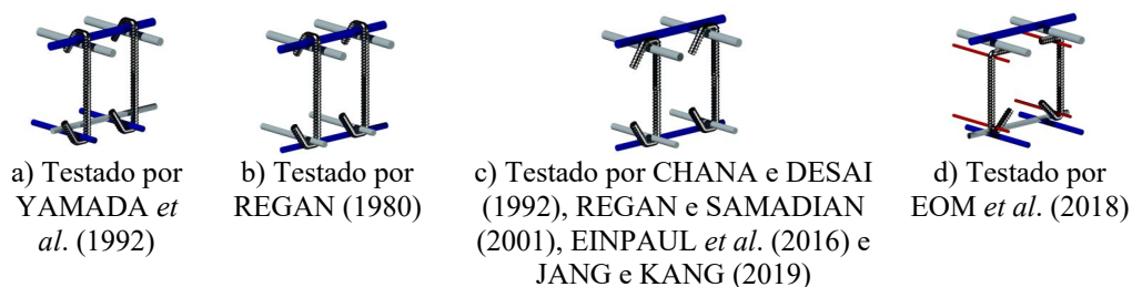
Figura 3.1 – Tipos de estribos individuais usados como armadura de combate à punção.
