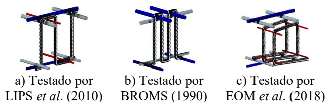
Figura 3.4 – Tipos de estribos contínuos usados como armadura de combate à punção.
